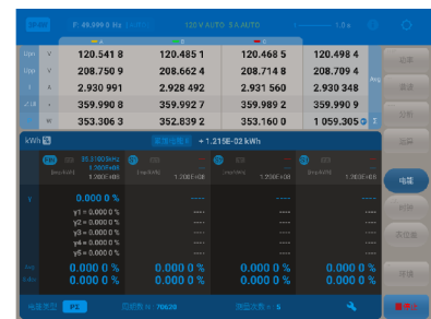
电能误差测量
